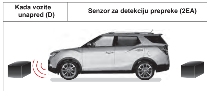
Prednji senzor radi u režimu vožnje(D)
