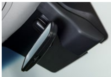
Modul prednje kamere (AEB/LDW/LKS/HBA/TSR) sa senzorom za kišu i jedinicom za automatsko upravljanje svetlima
