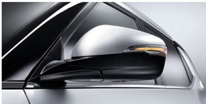
Spoljni retrovizor sa ugrađenim LED bočnim migavcima
