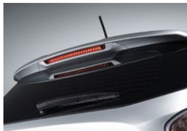
Zadnji spojler sportskog izgleda sa visoko postavljenim LED stop svetlom
