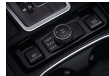
Parkirna kočnica električnog tipa sa auto-hold funkcijom
