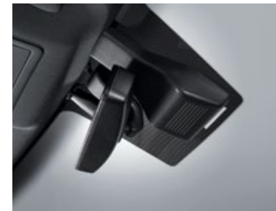
Prednja kamere sa senzorom za kišu i jedinicom za automatska svetla
