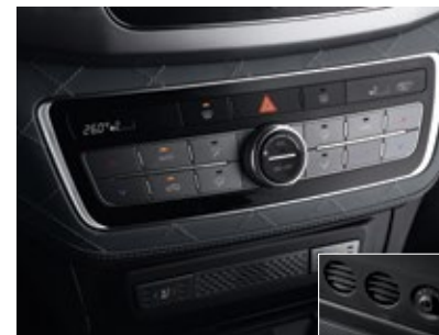
Dvozonski potpuno automatizovani uređaj za klimatizaciju
