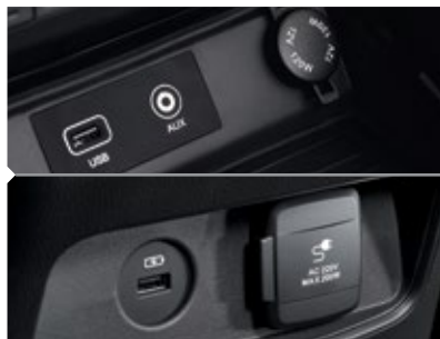
USB i strujna utičnica na centralnoj konzoli USB i 220V/115V inverter u drugom redu
