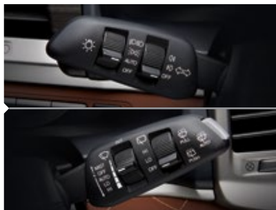
Upravljanje prednjim svetlima i prekidač automatske prskalice
