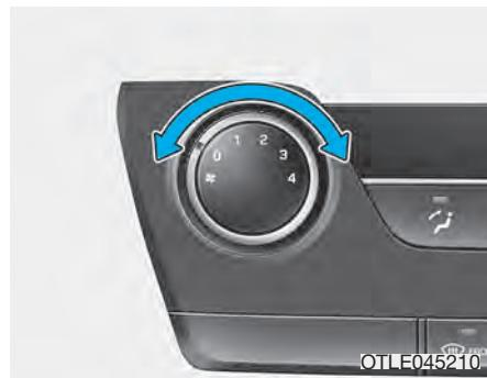
Taster za paljenje mora biti u položaju ON za rad ventilatora. Taster za kontrolu brzine ventilatora omogućava kontrolu brzine strujanja vazduha iz ventilacionog sistema kroz ventilator. Kako biste promenili brzinu ventilatora okrenite taster desno za višu brzinu ili levo za nižu brzinu.
