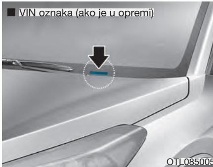
VIN je takođe na pločici pričvršćenoj na vrhu komandne ploče. Broj na pločici se lako može videti kroz vetrobransko staklo spolja.
