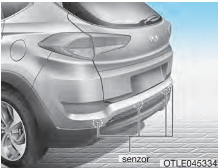
Sistem za parkiranje unazad pomaže vozaču tokom pokretanja vozila unazad tako što zazvoni ukoliko senzor oseti objekt na 50 inča udaljenosti (120 cm). Ovo je dodatni sistem koji detektuje objekte u blizini i dometu senzora, ne može otkriti objekte u drugim područjima gde senzor nije instaliran.
