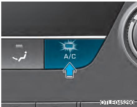
Pritisnite taster A/C kako biste uključili sistem za klimatizaciju (zasvetleće lampica). Ponovno pritisnite taster kako biste isključili sistem.
