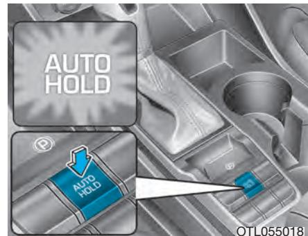
1. Sa zatvorenim vozačevim vratima, poklopcem motora i prtljažnikom, pričvrstite sigurnosni pojaz vozača ili pritisnite papučicu kočnice i pritisnite [AUTO HOLD] prekidač. Beli indikator AUTO HOLD će se upaliti i sistem će biti u pripravnom položaju.
