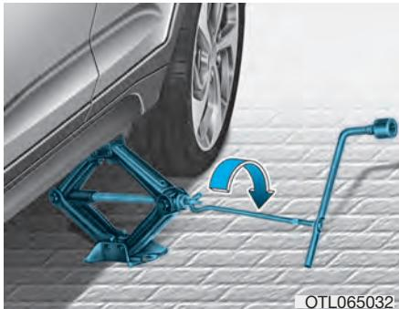
8. Umetnute ručku dizalice u dizalicu i okrećite ju u smjeru kazaljke, podižući vozilo dok guma ne dodiruje tlo. Proverite je li vozilo stabilno na dizalici.
