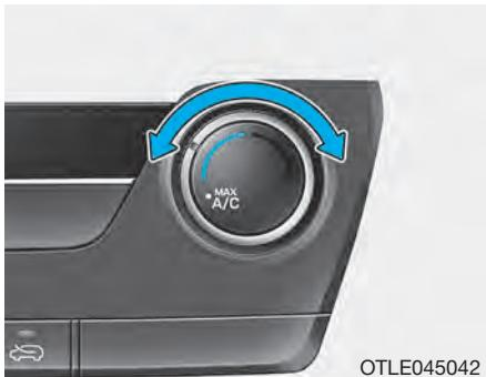
Taster za kontrolu temperature omogućava kontrolu temperature vazduha koji struji iz ventilacionog sistema. Kako biste u prostoru za putnike promenili temperaturu, okrenite taster prema desno za topli i vrući vazduh i prema levo za hladniji vazduh.
