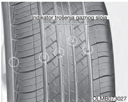
Ako je guma istrošena ravnomerno, indikator istrošenosti pojaviće se na profilu gume u obliku ravnomerne trake. To pokazuje da je ostalo manje od 1,6 mm omotača na gumi. Zamenite gumu kada se to dogodi.
