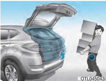
Na vozilu opremljenom pametnim ključem, vrata gepeka se mogu otvoriti aktivacijom bez dodira pomoću sistema Pametnih vrata gepeka.
