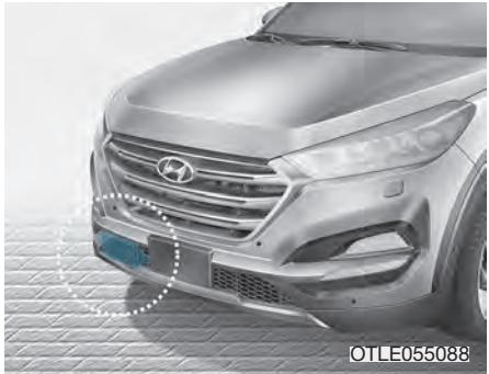
Senzor pomaže pri održavanju određene udaljenosti od vozila ispred. Međutim, sočivo senzora zamrljano drugim česticama, kao što su sneg i kiša, negativno utiče na rad senzora. To čak može privremeno otkazati AEB. Uvek senzor održavajte čistim.
