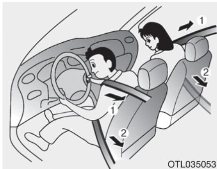
Vaše vozilo je opremljeno zatezačima sigurnosnih pojaseva za vozača i suvozača (Retractor Pretensioner and Emergency Fastening Device (EFD)). Svrha zatezača je da sigurnosni pojasevi čvrsto stope uz tela putnika u frontalnim sudarima. Zatezači sigurnosnih pojaseva mogu se aktivirati kad je frontalni sudar dovoljno jak, zajedno sa vazdušnim jastucima.
