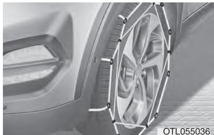
Budući da su bočni zidovi radikalnih guma tanje od drugih vrsta guma, gume mogu biti oštećene montažom nekih vrsta lanaca za gume na njih. Stoga, preporučuje se upotreba zimskih guma umesto lanaca.
