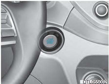
Kad god su ulazna vrata otvorena, taster Start / Stop će svetleti i ugasiće se 30 sekundi nakon zatvaranja vrata.
