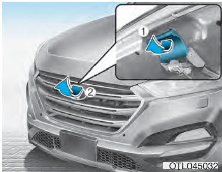
3. Otiđite do prednjeg dela vozila, malo podignite poklopac motora, povucite gore do drugog položaja (1) unutar središta poklopca i podignite poklopac (2).
