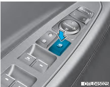
Vozač može onemogućiti za rad prekidače električnih prozora putnicima na zadnjim vratima pritiskom na prekidač zaključavanja prozora.
