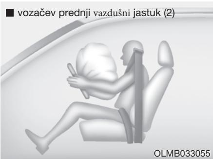
Nakon aktivacije, šavovi poklopca će se odvojiti pod pritiskom širenja vazdušnih jastuka. Dalje otvaranje poklopca omogućuje potpuno naduvavanje vazdušnih jastuka.
