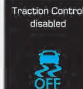
Kratko pritisnite ESC OFF taster (ESC OFF indikator i poruka svetli). U tom stanju, funkcija kontrole motora ne radi. Funkcija kontrole proklizavanja ne radi već samo deluju kontrola kočenja.
