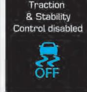
Pritisnite taster ESC OFF duže od 3 sekunde. ESC OFF lampica i poruka će svetleti i oglasiće se ESC OFF upozoravajući zvučni signal. U tom stanju ne radi funkcija kontrole motora i funkcija kontrole kočnica. Funkcija kontrole stabilnosti vozila više ne rade.
