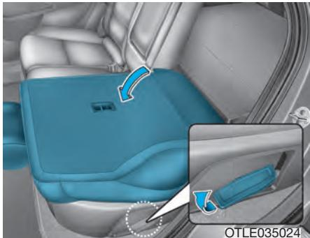
4. Podignite prednji deo poluge za preklapanje naslona sedišta, zatim preklopite sedište prema prednjem delu vozila. Kada vratite sedište u uspravan položaj, uvek budite sigurni da je zaključano u položaju pritiskom na vrh naslona sedišta.
