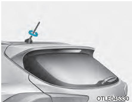
Krovna antena prima AM i FM radio signale. Okrećite krovnu antenu u smeru suprotnom od kazaljki na satu kako biste je uklonili. Okrećite u smeru kazaljke na satu kako biste je ponovno postavili.
