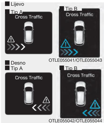
Ako se detektovano vozilo približava vašem vozilu, oglasiće se zvuk upozorenja, treptaće svetlo upozorenja na spoljašnjem retrovizoru i pojaviće se poruka na LCD ekranu.
