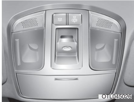
Ako je vaše vozilo opremljeno krovnim prozorom, možete pomerati ili nagnuti krov s prekidačem za upravljanje krova koja se nalazi na konzoli na plafonu.
