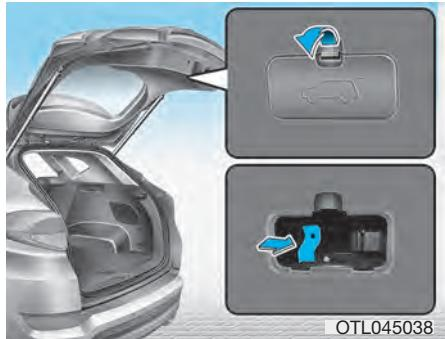
Vaše je vozilo opremljeno sigurnosnom ručicom za otvaranje vrata gepeka u nuždi koja se nalazi na dnu gepeka. Kada se neko slučajno zaključa u gepeku, vrata se mogu otvoriti na sledeći način:
