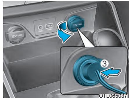
7. Spojite kompresor i utičnicu vozila pomoću kabla i konektora.
