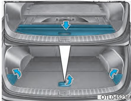
3. Otvorite fioku za prtljag i stavite navlaku u fioku.
