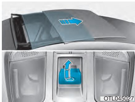
Ako povučete prekidač za krov unazad do drugog položaja, štitnik za sunce će se otvoriti klizanjem, a onda će se klizanjem otvoriti i krovni prozor. Za zaustavljanje kretanja pokretnog krova u bilo kom trenutku, odmah povucite ili gurnite prekidač za krov.
