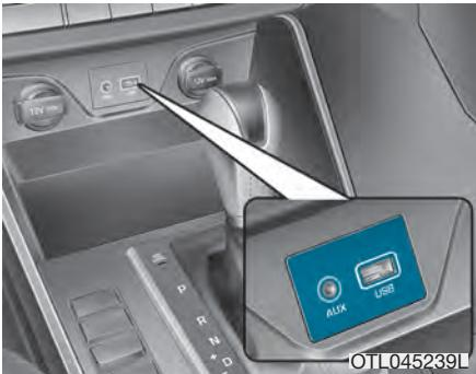
Možete koristiti AUX priključak za spajanje audio uređaja i USB port priključak za spajanje na USB i iPod®.
