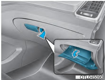
Kako biste otvorili kasetu za rukavice povucite ručicu i kasetu će se automatski otvoriti. Nakon korišćenja zatvorite kasetu za rukavice.
