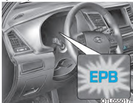
Ako indikator kvara EPB ostaje upaljen, zasvetli za vreme vožnje ili se ne pali kad se taster motora Start / Stop promenio u položaj ON, to znači da je EPB možda u kvaru.
