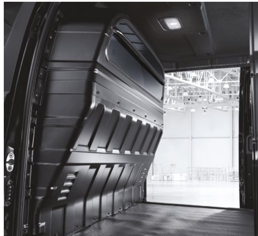
Pregradni panel za razdvajanje putničkog od prtljažnog prostora
