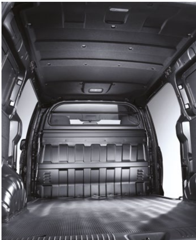
Tretni prostor kombija sa 2/3 sedišta i pregradnim panelom
